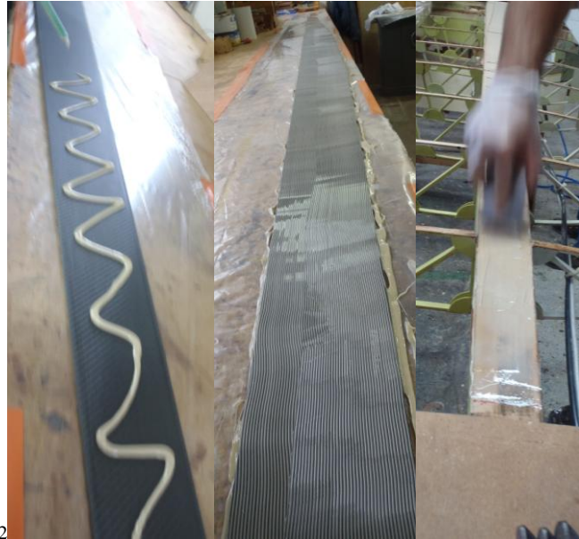
N°2 Cordon de colle déposé, strié, sur carbone et longeron bois de voilure.
